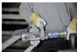
HCS8 S оснащены серповидными лезвиями, подходят для резки листового металла, труб, высоковольтных проводов, арматуры (до 16 мм в диаметре) и деревянных каркасов. Форма лезвий обеспечивает надежный захват и предотвращает соскальзывание ножниц.
