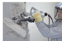
HCS8 C разработаны для работы на скатие, для таких работ, как фрагментация бетона, или разжатие, например, с их помощью можно отсоединить радиатор или дверную коробку от стены. В комплекте с инструментом идет набор лезвий для резки различных материалов, таких как арматура (до 20 мм в диаметре).
